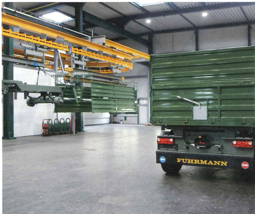
Aufgrund der Abmessungen von Kabinen und Öfen können Werkstücke bis zu einer Größe von 7000 x 2300 x 2500 mm (Länge x Breite x Höhe) transportiert werden. Quelle (zwei Bilder): Caldan Conveyor
