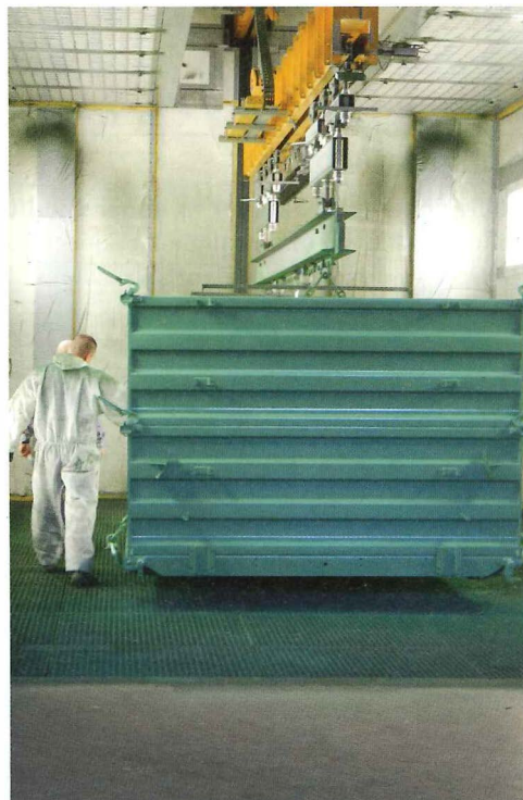
Die Einzelarbeitsplätze sind, wie hier in der Lackierkabine, mit Hub- und Senkstationen ausgestattet.
