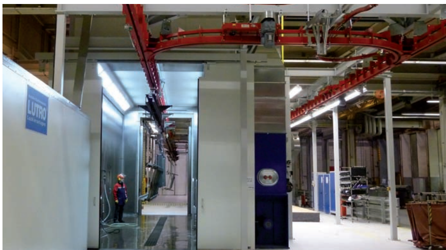
Die kombinierte Reinigungs- und Trocknungskabine bietet wie die Lackierkabine mit 10 x 4 x 5 Metern Größe viel Platz. Bilder: Lutro
