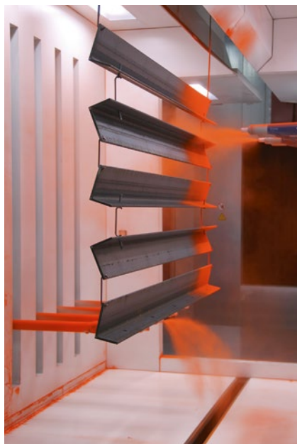
Die Automatikbeschichtung erfolgt mit zweimal vier Pistolen. Der Kabinenboden wird sequenziell abgeblasen.
