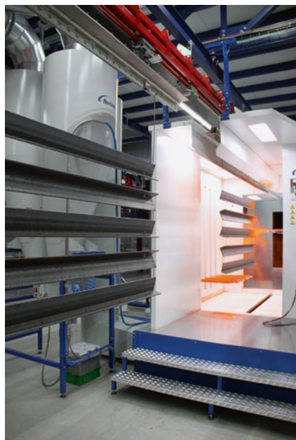
Die Automatikkabine basiert auf einem Standard-Schnellfarbwechselkonzept und wurde den knappen räumlichen Gegebenheiten angepasst.
