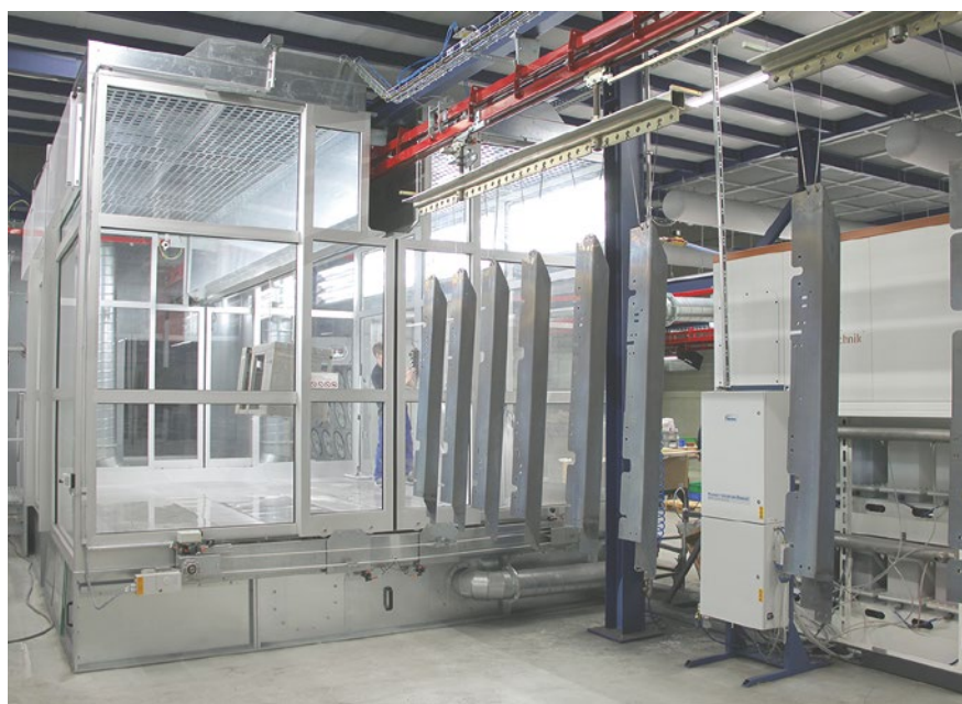
Die Handbeschichtung erfolgt auf Verlust in einer 5,5 x 4,1 Meter großen Glaskabine.
