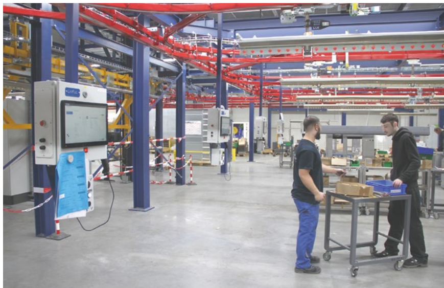
Die Anlage verfügt über fünf Aufgabe- und drei Abnahmeplätze.
