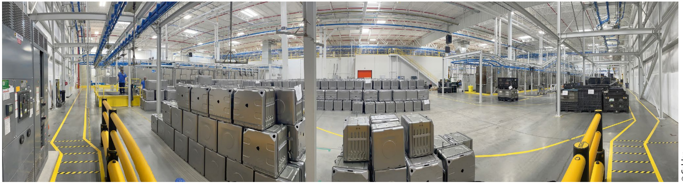
Blick in Richtung Beschichtung, unter der Hallendecke befindet sich der Puffer (hinten oben im Bild), in dem die Backkästen zwischengepuffert und auch zu Batches zusammengestellt werden.
