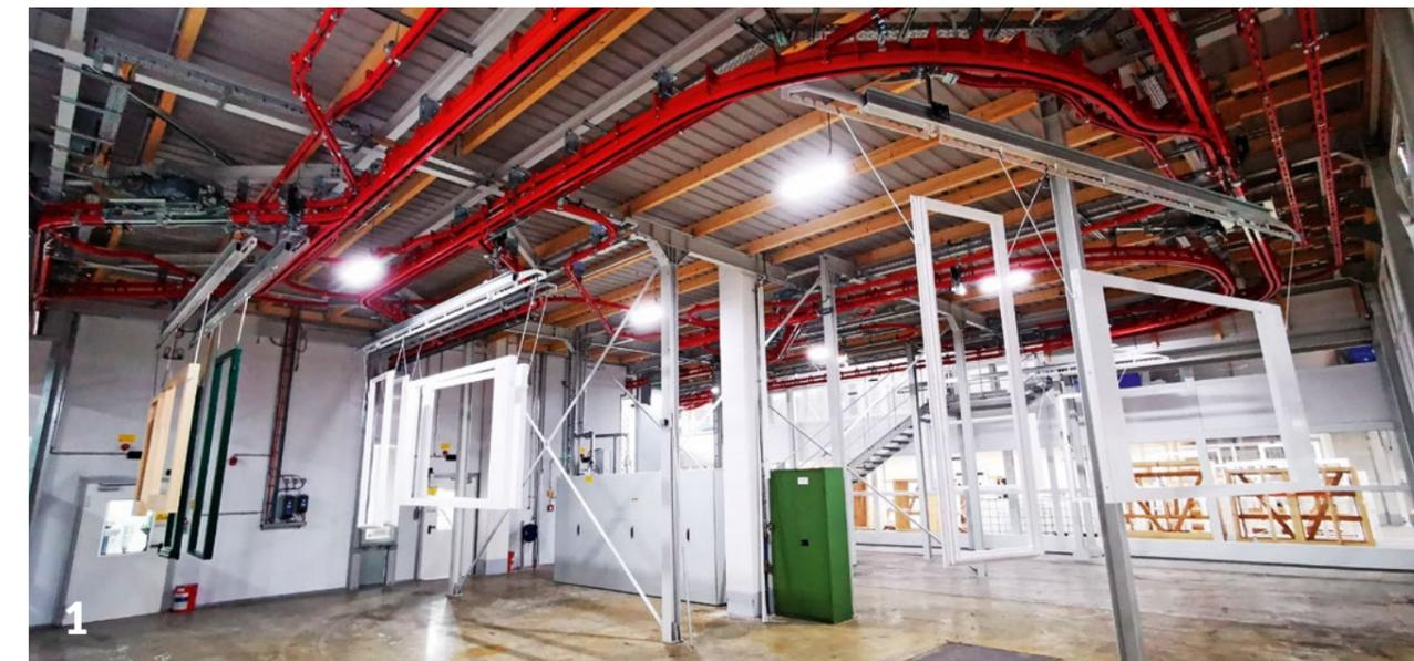
1: Blick in die installierte Beschichtungsanlage, in die die Wertbau GmbH rund 8,5 Mio Euro investiert hat. Heute kann das Unternehmen nun täglich 1300 m<sup>2</sup> oder 420 Fenster im Zwei-Schichtbetrieb beschichten
