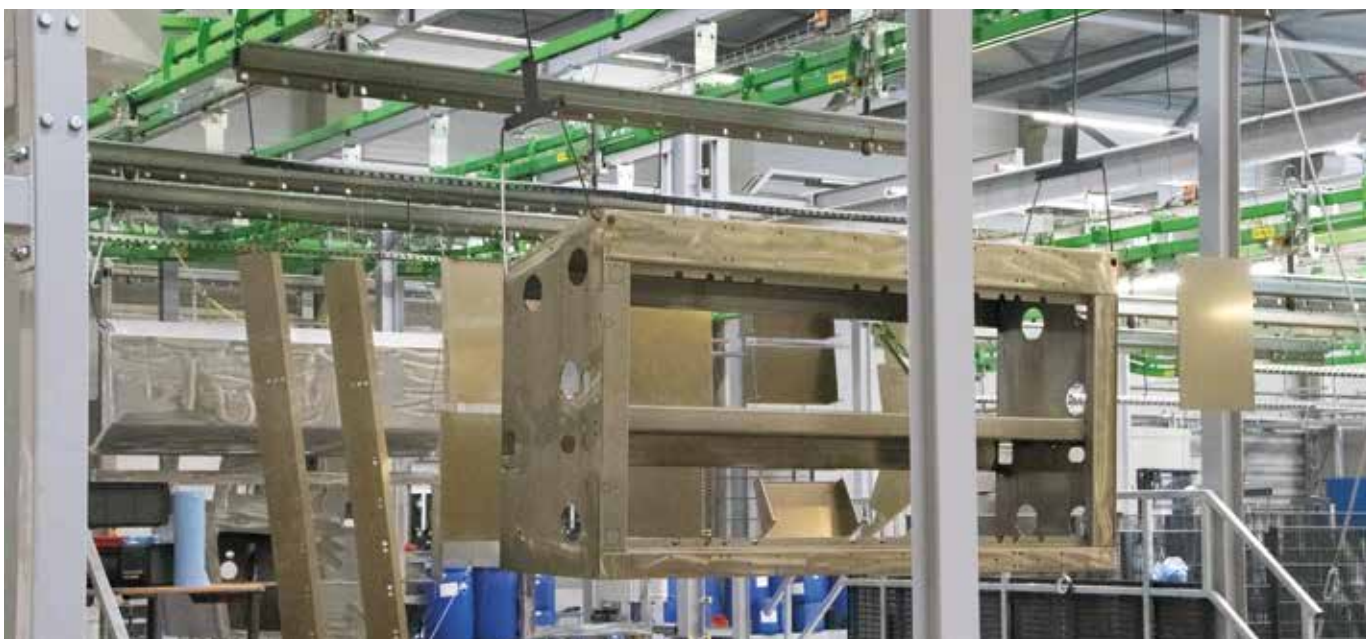
Die chromfreie Vorbehandlung auf Zirkon-Silan-Basis bietet auf Stahl einen guten Korrosionsschutz und auf Edelstahl einen guten Haftgrund. Die erfolgreiche Vorbehandlung lässt sich an dem goldenen Schimmer erkennen. Aufwändige Schweißkonstruktionen sind eine Spezialität der Reku Gruppe.
