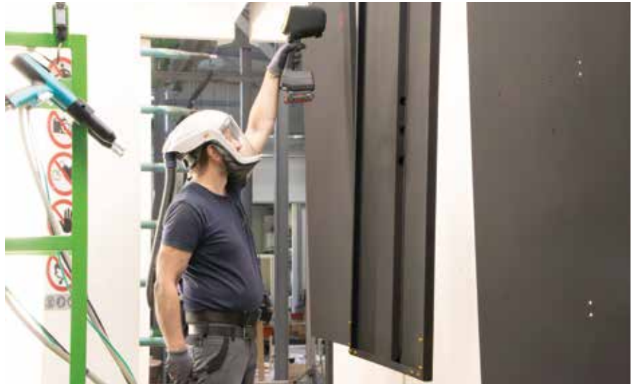
Kritische Stellen werden per Coatmaster Flex, hier im Schutz-Cover, im Schnelldurchgang gemessen und dann regelt die Anlagensteuerung im Rahmen der Sollwerte automatisch und blitzschnell nach.
