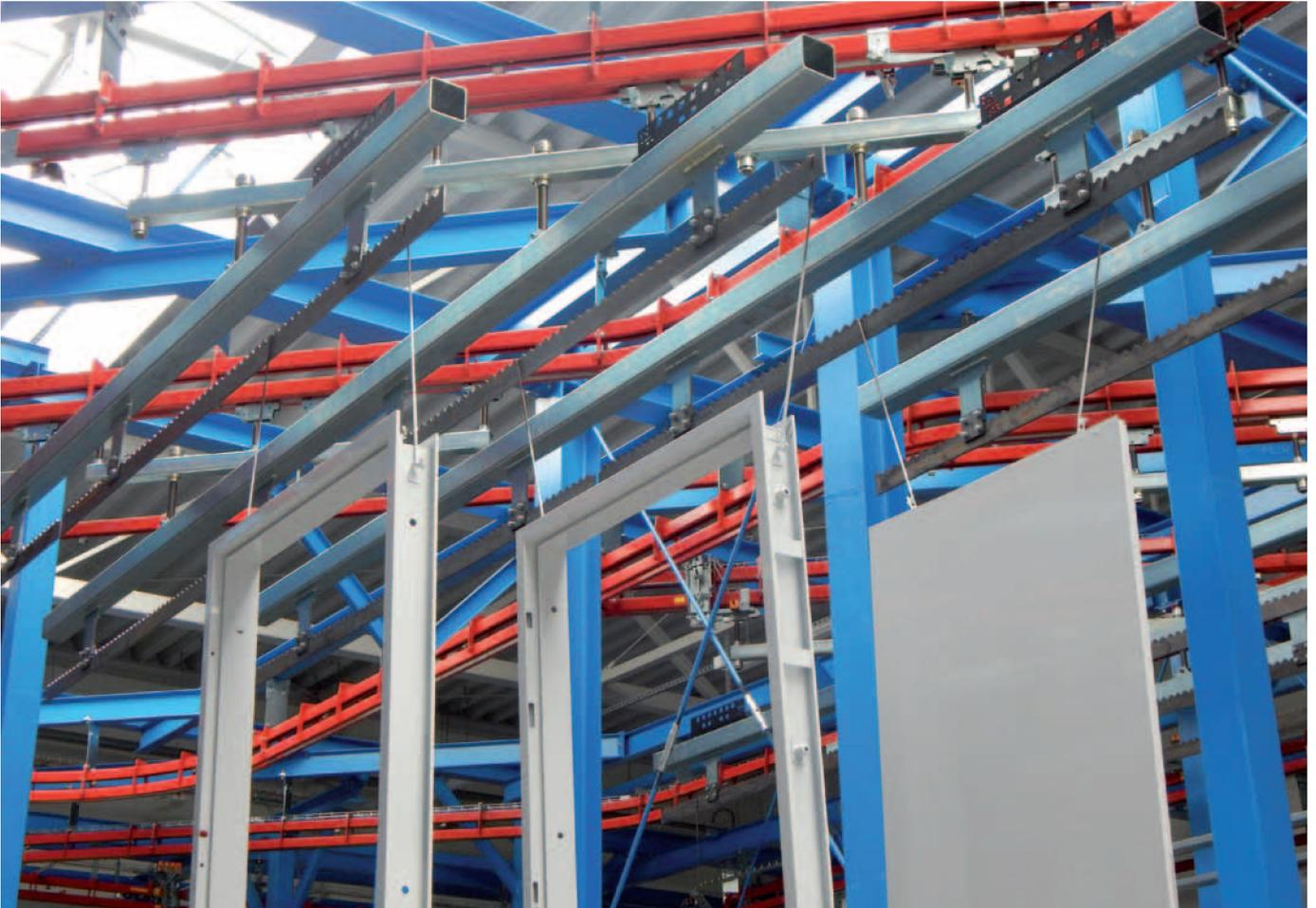
13 platzsparende Schrägpufferspeicher sorgen dafür, dass die Anlage atmen kann und in Vorbehandlung und Lackierkabine die Prozesszeiten etwas schwanken können. Auch beim Leerfahren bei einer Störung oder Feierabend sind die Puffer wichtig.
