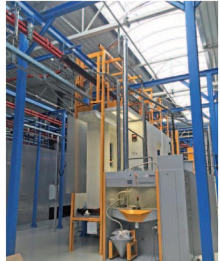
Lackiert werden Türzargen und Türblätter in zwei automatischen Pulverkabinen.
