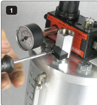
1 Schraube in Bedienungsgriff, Kugelhahn, abschrauben (wird wieder verwendet).
