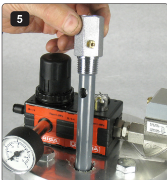
5 Neue Kugelhahn montieren.
