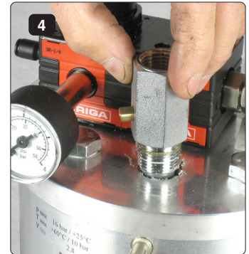
4 Kugelhahn abbauen (wird nicht wieder verwendet).
