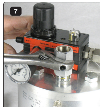
7 Neue Kugelhahn mit Schlüssel fest- schrauben (Montageloch für Bedie- nungsgriff in Manometerrichtung).
